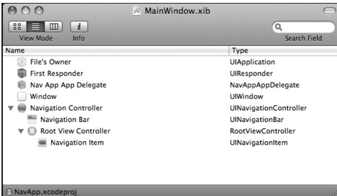
Figure 5.28 : Contrôleur de navigation dans un fichier NIB
