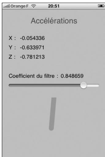
Figure 12.5 : Application avec un filtre numérique
