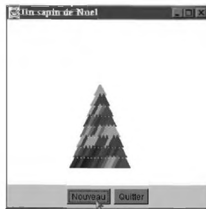
Figure 11-4 Une fois la position des composants définie par rapport aux bords de la fenêtre principale, chaque composant s'affiche correctement.
