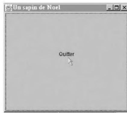
Figure 11-3 Les composants graphiques s'affichent en se superposant les uns aux autres. C'est pourquoi le dernier bouton cache les autres composants.
